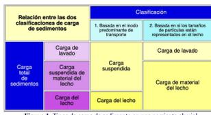
Figura 1. Tipos de carga de sedimento en una corriente aluvial
